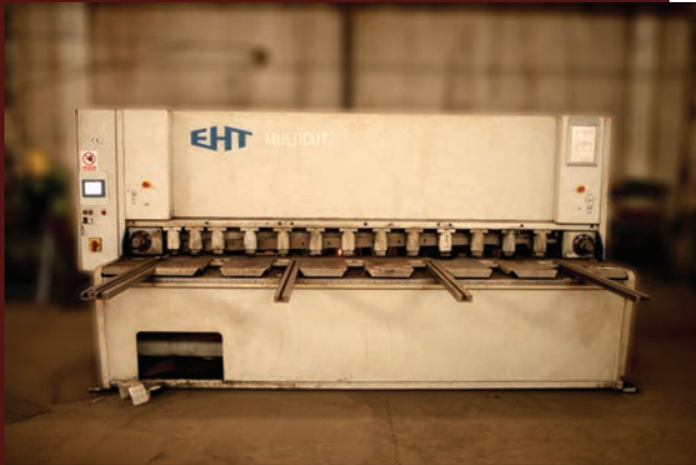
4.CNC makaze za sječenje limova (do 16 mm debljine, na dužini od 3000 mm) CNC sheet cutting shears (max. sheet thickness of 16 mm, a length of 3000 mm)
