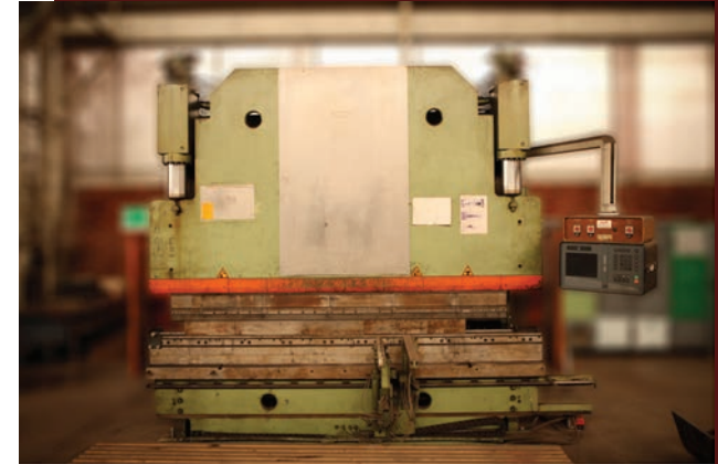
5.CNC abkant hidraulična presa (do 15 mm debljine, na dužini od 3000 mm) CNC brake press 125 t (max. sheet metal bending up to 15 mm thick, the length of 3000 mm)
