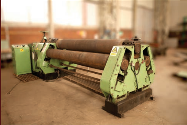
2.Rolo-valc mašina za kružno savijanje do (15 mm debljine, na dužini od 3000 mm) CNC roll machine (bending sheets up to 15 mm in length 3000 mm)
