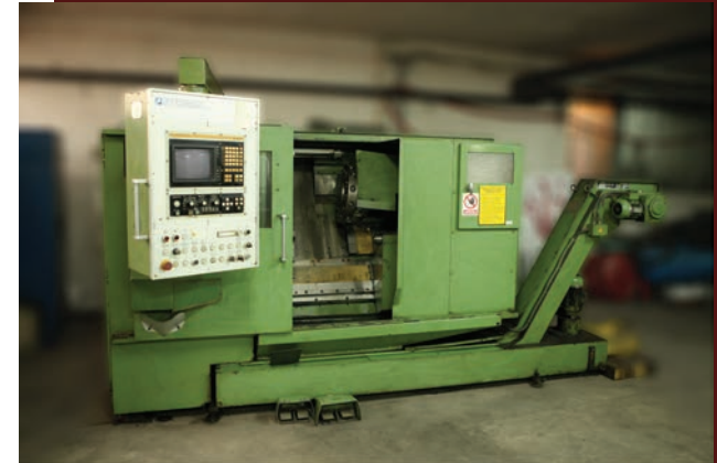
3.CNC tokarski stroj Maksimalna dimenzija obrade fi 320 mm dužine 450 mm CNC lathe mashine Pittler (max. size of piece , dia. Ø320 mm, l = 450 mm)
